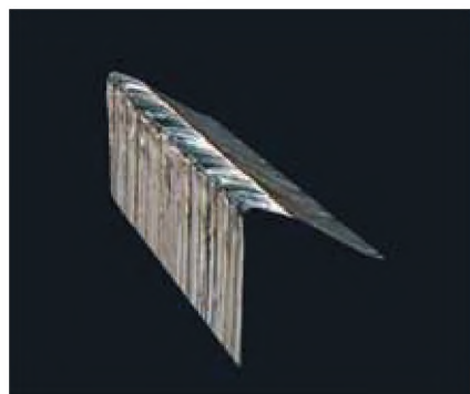
Износ с острой гранью на режущей кромке из быстрорежущей стали (HS) с покрытием
