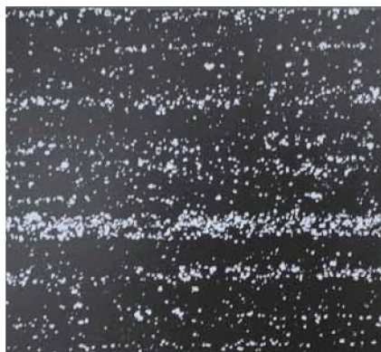
Слоистая структура стали HS, изготовленной методом плавки
