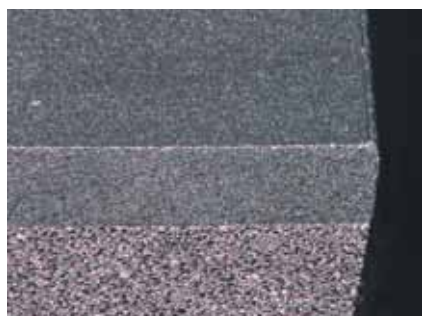
Пластина из поликристаллического алмаза - DP (верхний слой), нанесенного методом спекания на твердосплавную основу (нижний слой)
