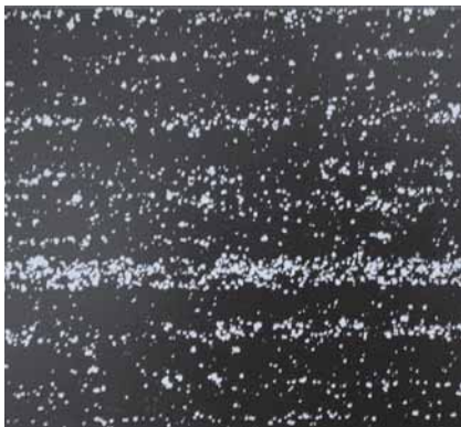
Слоистая структура стали HS, изготовленной методом плавки
